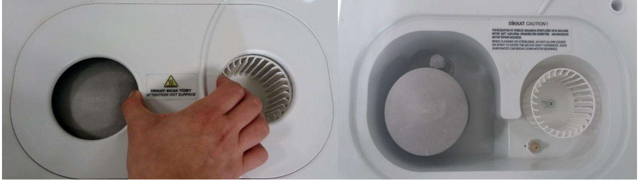
Şekil 50 :Üst Plakanın Sökülmesi
