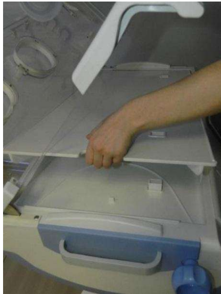
Şekil 49 :Alt Tepsinin Sökülmesi
