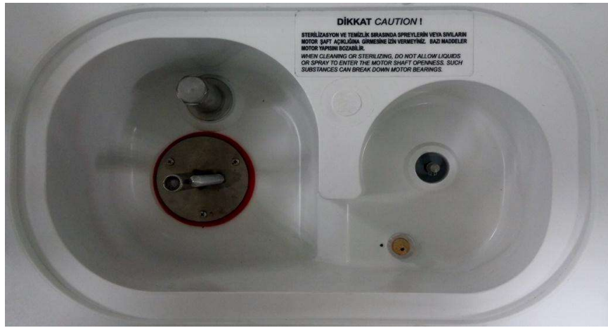
Şekil 53 :Fan ve Isıtıcı Çıkarıldıktan Sonra Kalan Yüzey
