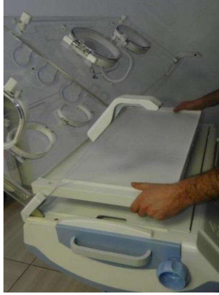
Şekil 47 :Alt Tepsinin Sökülmesi
