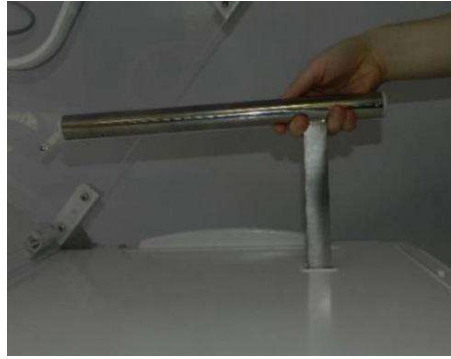
Şekil 48 :Trendelenburg Mekanizması Kaldırıcılarının Sökülmesi
